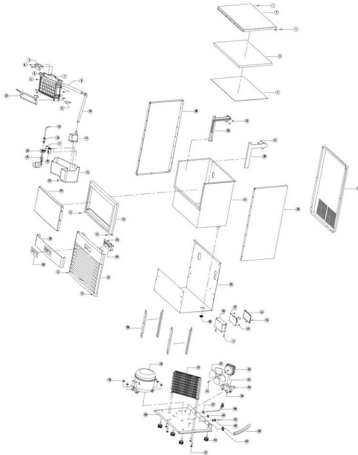
Рис1 Основные элементы оборудования для модели ВY-450F
